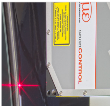
Mesure de fente sur carrosserie
