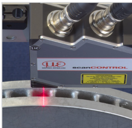
Mesure de profil sur le disque de frein
