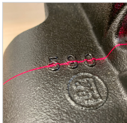
Détection de l'inscription sur la pièce moulée
