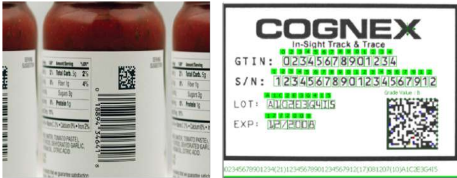
Figura 6. Las técnicas de identificación pueden ir desde simples escaneos de códigos de barras hasta OCR.
