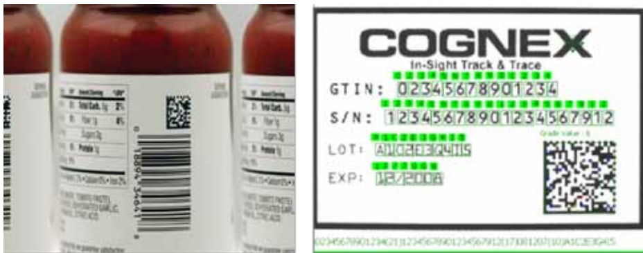
Figure 6. Les techniques d'identification peuvent aller de la simple lecture de codes-barres à la reconnaissance optique de caractères.
