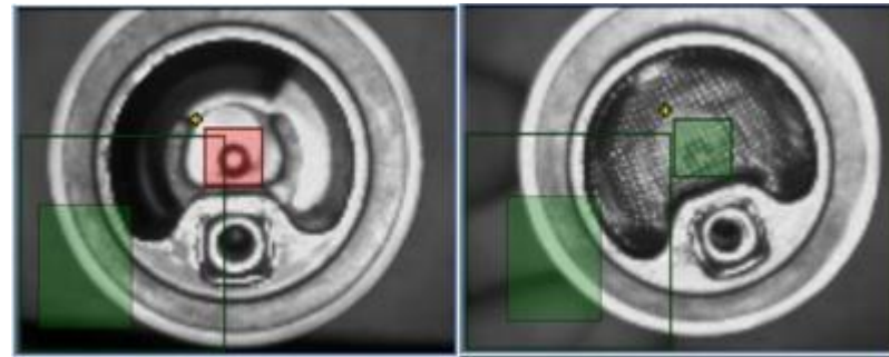
Verificación de filtro en tanque de combustible
