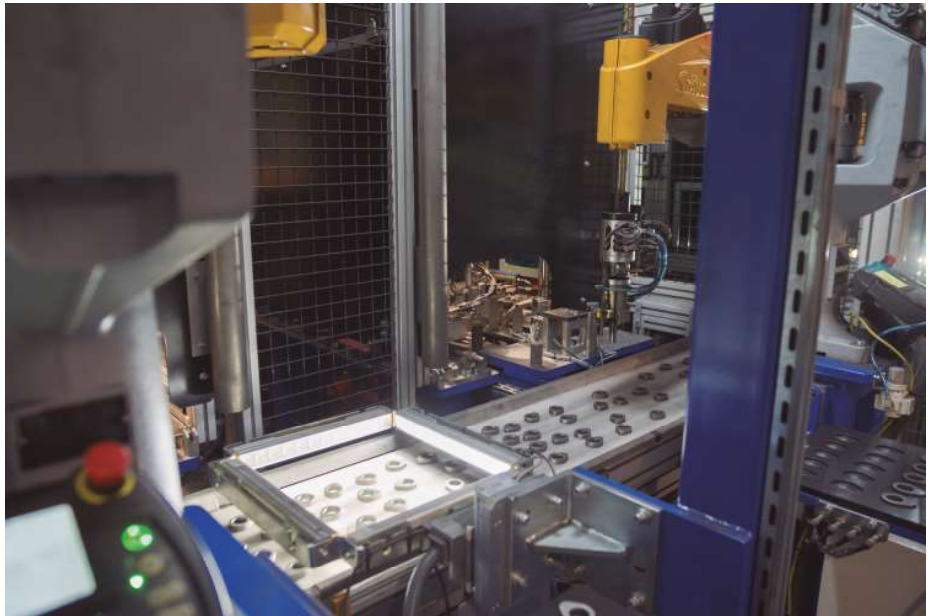
Piezas localizadas por un sistema de visión 2D de Cognex y recogidas gracias a robots Staübli
