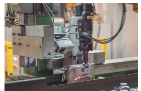
Inspección mediante cámaras láser 3D de SmartRay
