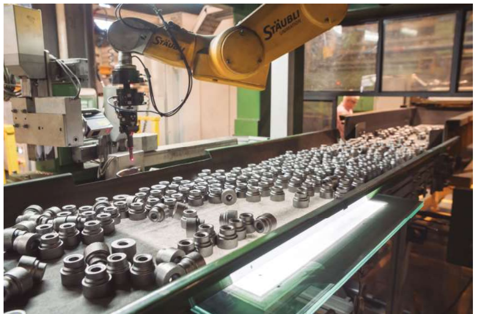
Piezas localizadas por un sistema de visión 2D de Cognex y recogidas gracias a robots Staubli
