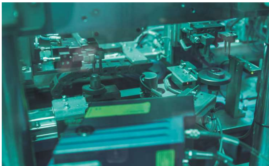
Inspección mediante cámaras láser 3D de SmartRay
