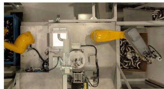
Caso de éxito Mitec y Isotubi - Célula automatizada de Bin Picking y control dimensional de tubos-
