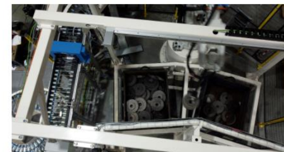
Caso éxito Ingemov -Bin picking para alimentación automática de líneas de mecanizado -
