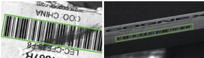
**1DMax™ avec Hotbars®** est optimisé pour la lecture omnidirectionnelle de codes-barres 1D et peut lire les codes de faible résolution dix fois plus vite qu'un lecteur classique.
