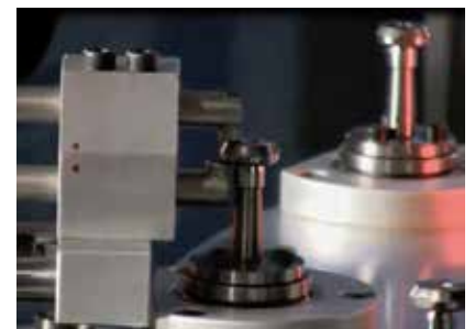
Detección de grietas mediante corrientes inducidas.
